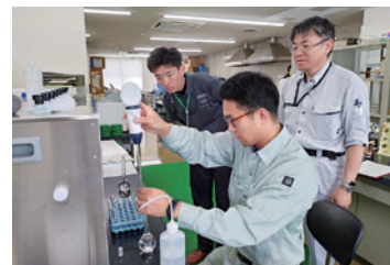
浄水処理用薬品を計量している様子 (富山県和田川水道管理所にて)
